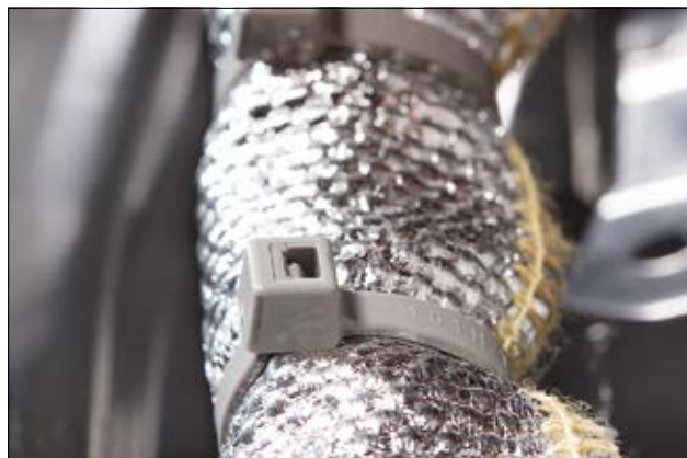
Opaski kablowe serii T o podwyższonej odporności na działanie temperatur, do +150°C przez 5000 godzin (PA46).
