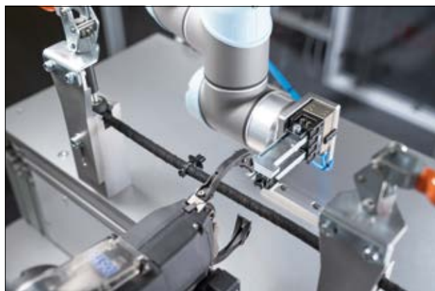
Zautomatyzowana aplikacja elementów mocujących.
