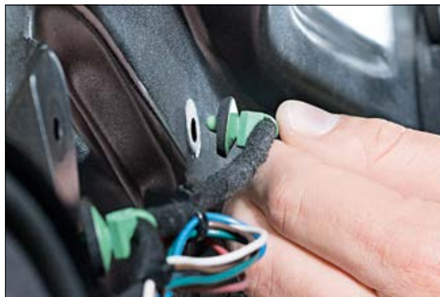
Uszczelka chroni otwór montażowy przed wnikaniem wilgoci.
