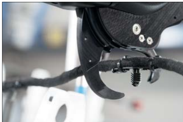
Uchwyty do taśmowania do systemów automatycznego wiązania opaskami kablowymi.
