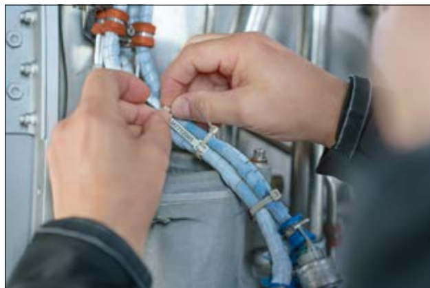
Zewnętrznie ząbkowana opaska kablowa i sztyld oznaczeniowy HFTP48 wykonane z materiału PEEK.
