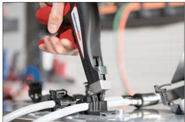
Prosta regulacja siły zaciągu za pomocą obrotowego pokręta w narzędziu z serii EVO.
