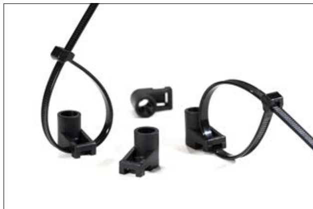
Element mocujący CTMS5 umożliwia prowadzenie wiązki wzdłuż bolca.
