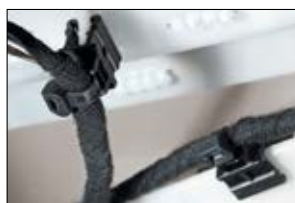
T50ROSEC10 zamocowany na krawędzi z tworzywa sztucznego.
